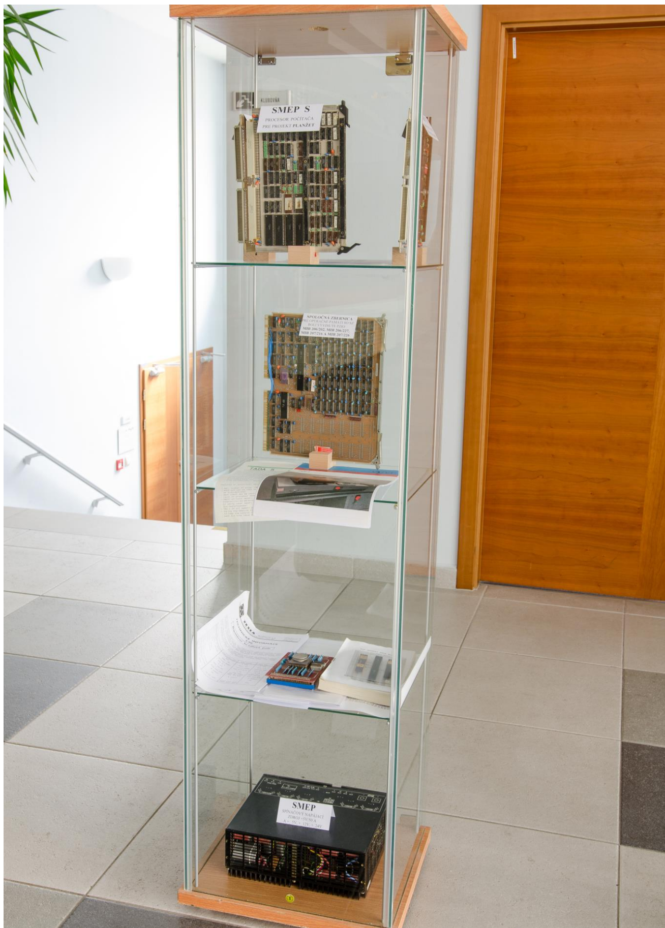
Obrázok 11: Vitrína s osadenými doskami plošných spojov špeciálnych počítačov a PZIO (polozákazníckymi integrovanými obvodmi) navrhnutými vo VÚVT Žilina.
